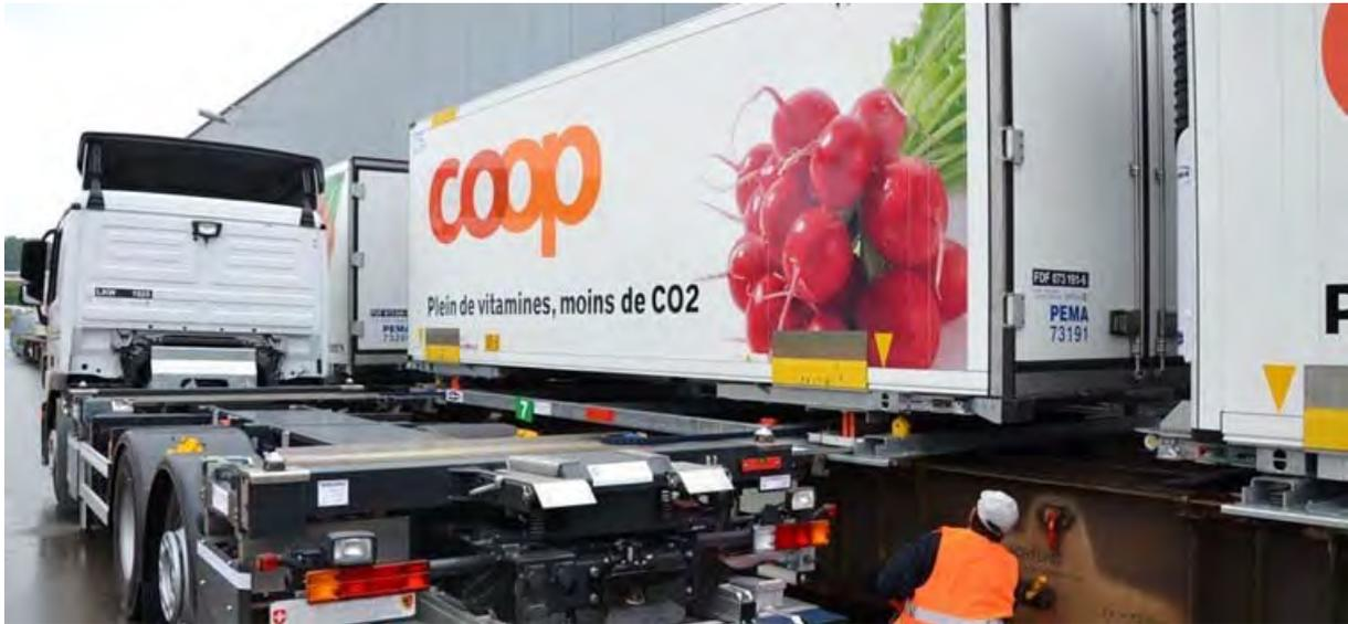
Abbildung 4-8: *Horizontalverschub über Wagenadapter und Umsetzen von Wechselbehältern mit dem ContainerMover-Lkw [14]*
