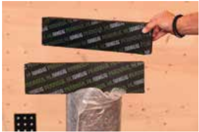
Industrierecycling: Dämmung aus Altglas
